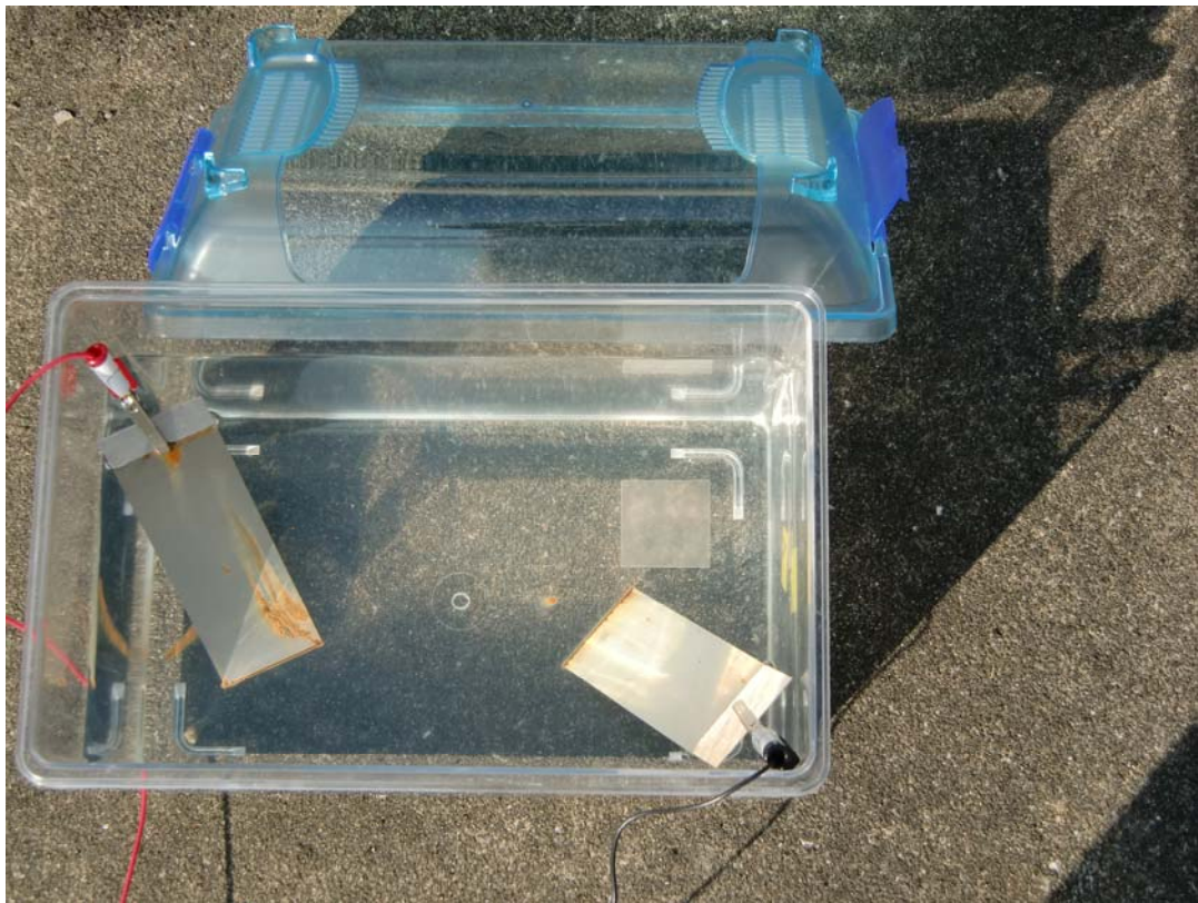
写真 17. 太陽光パネルによる鉄の電気分解の実験（パネルあり・2日目）
