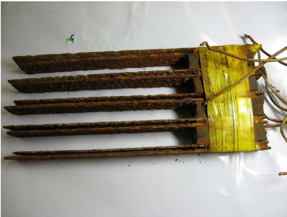
写真 27. 汚泥を除去した電極 B
