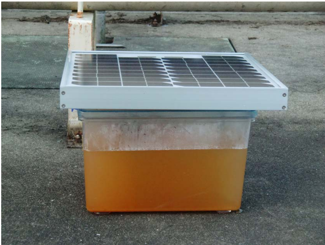
写真 14. 太陽光パネルによる鉄の電気分解の実験（パネルあり・1日目）
