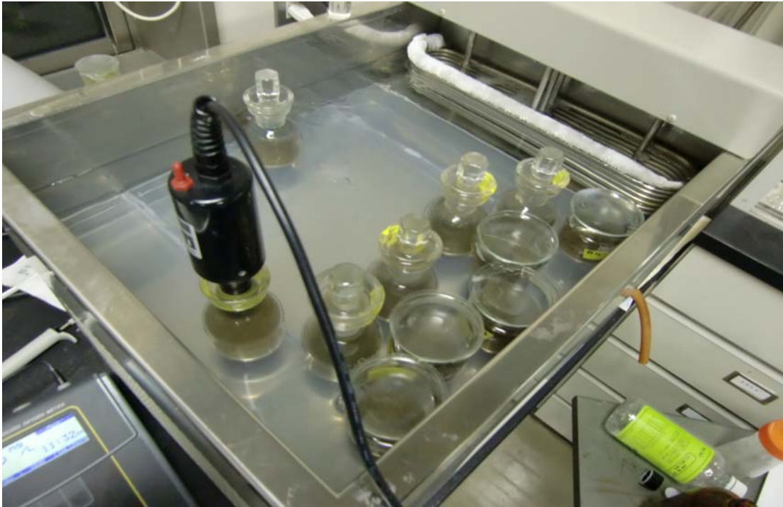
写真 12. 水浴槽で DO を計測している様子
