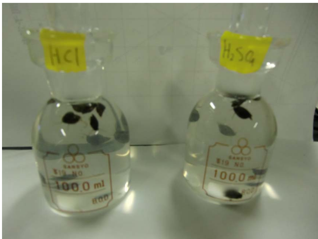
写真 14. H 2 SO 4 及び、HCl を用いたサカマキガイの死滅実験
