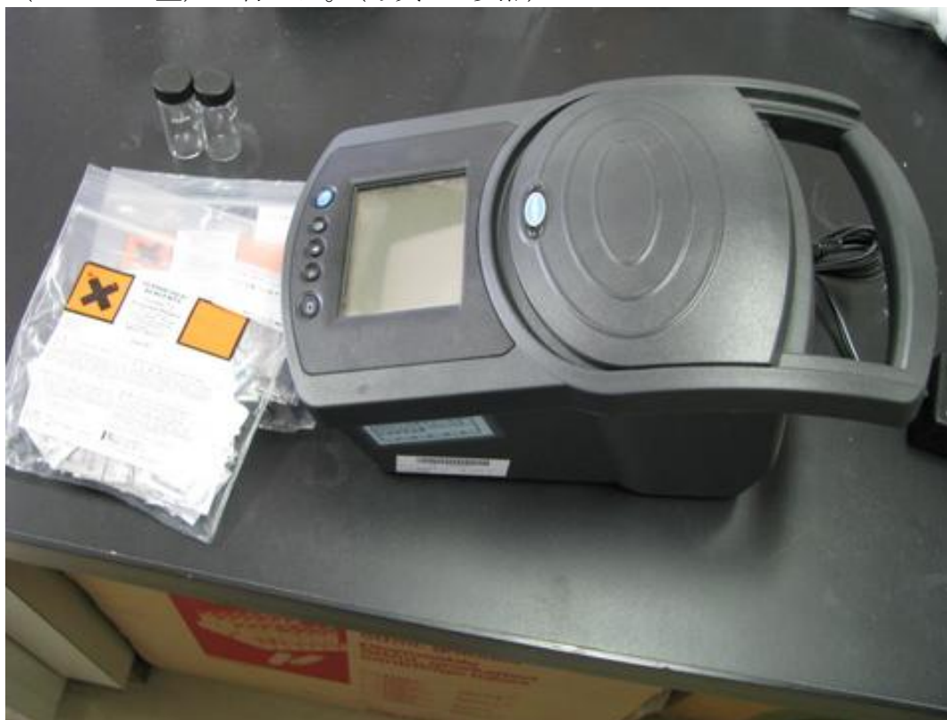
写真 13. 携帯用多項目水質分析計
