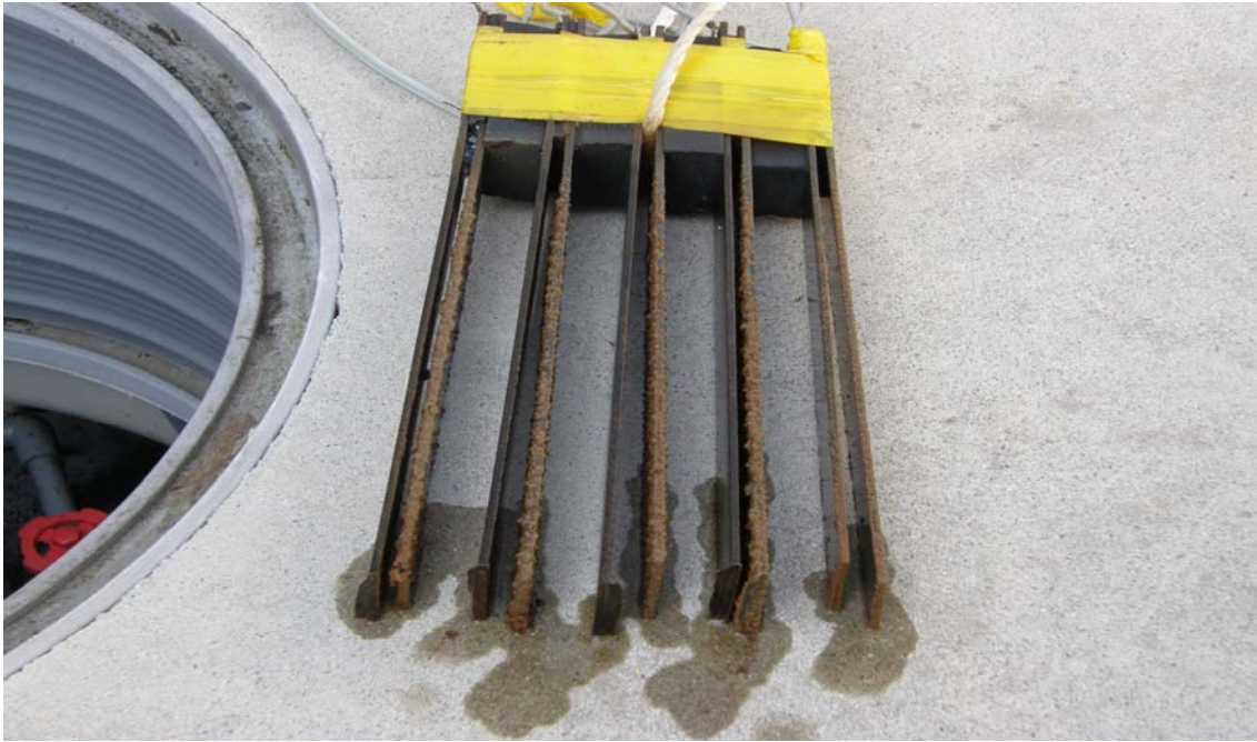
写真 26. 期間 B に用いた電極（電極 B）の写真
